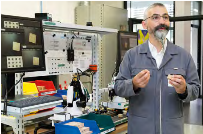
CI-DESSUS : Banc d'essais pour tester un algorithme d'intelligence artificielle avec des neurones artificiels chargés de classifier des objets (ici diverses essences de bois) selon leurs caractéristiques. Un procédé de plus en plus développé dans l'industrie pour la sécurité, par exemple détecter la présence d'une personne.
