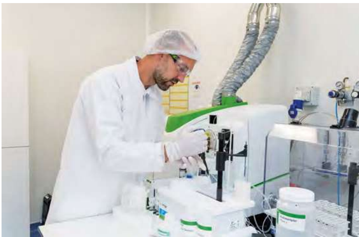
CI-DESSUS : Dans la salle blanche du laboratoire de biométrie, travail avec un spectromètre de masse pour mesurer les polluants retrouvés dans les fluides biologiques suite à l'exposition d'un salarié. L'appareil est capable de détecter des molécules à l'échelle d'un grain de sel dans une piscine olympique.
