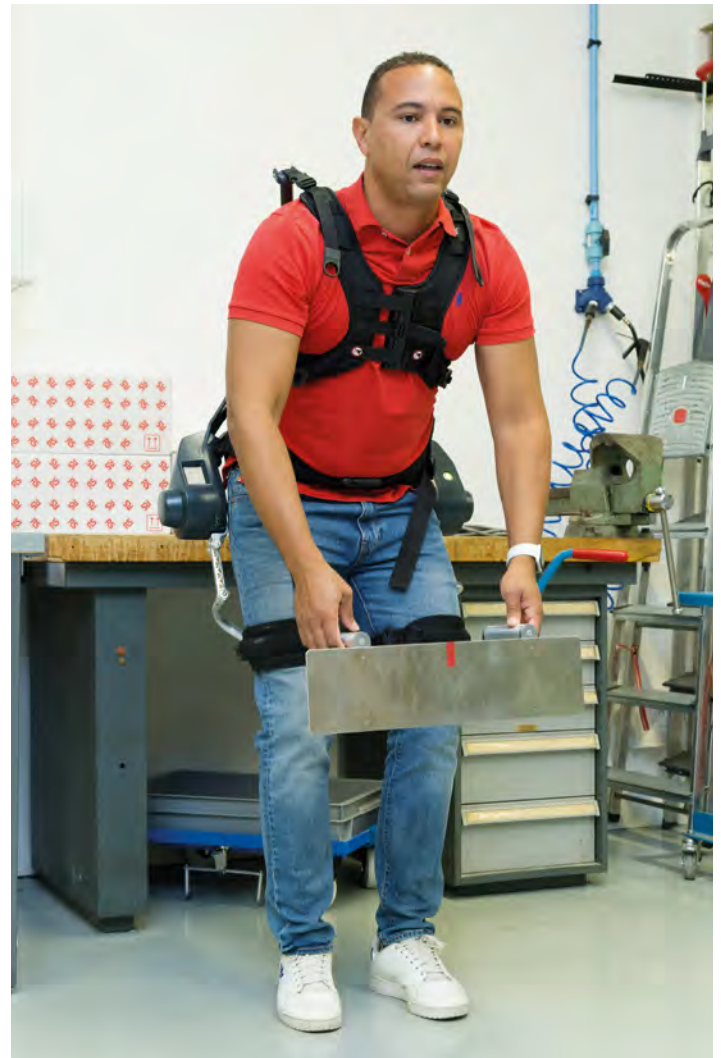
CI-DESSUS : Pour l'aider à déplacer ce bloc de 15 kilos, le sujet est ici équipé d'un modèle d'exosquelette motorisé, un équipement visant à réduire la charge physique et à prévenir les risques de troubles musculosquelettiques (TMS). L'INRS effectue des analyses (capteurs, électrodes électromyographiques...) pour en évaluer les bénéfices et les possibles contraintes, et conseiller les entreprises tentées par l'acquisition de ces technologies d'assistance physique.
