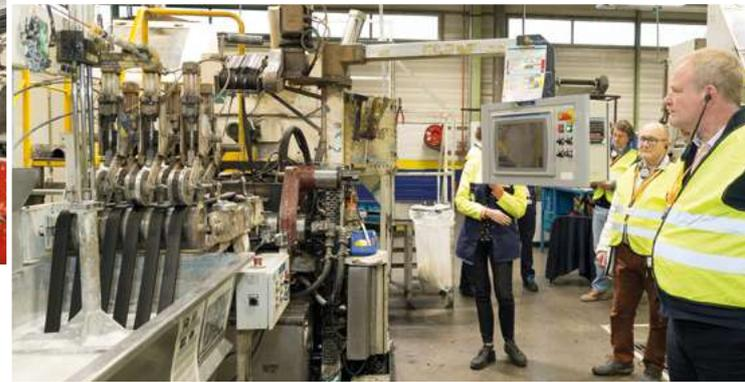
**CI-DESSUS :** Les bandes de gomme passent dans un bain d'anticollant afin de pouvoir être enroulées sur des bobines.
