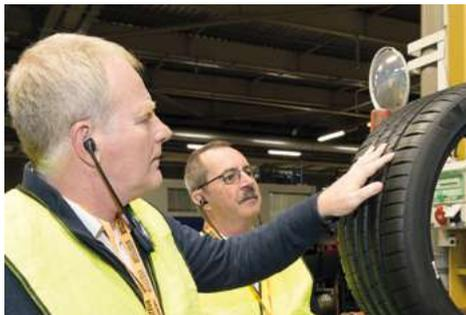
Les pneus fabriqués arrivent sur des postes-aspect pour vérification visuelle et tactile. Le côté « velours » (côté jante) du pneu, en particulier, doit être conforme aux exigences des clients haut de gamme. Les enveloppes conformes à la fiche de tolérance produit (FTP) partent ensuite sur le buffer (poste de scopie) qui les analyse aux rayons X.
